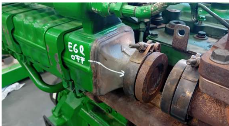
2. ábra - Kiiktatott EGR, az égési hőmérséklet megemelkedik, ami nem tervezett tartományba viszi a motort
