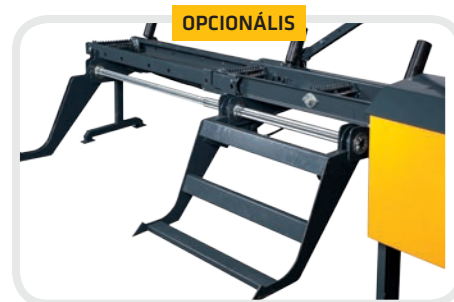
Hidraulikus teleszkópos emelőasztal max. 4000 mm - es rönköknek.
