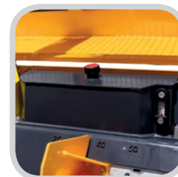
A lánc kenésére szolgáló olajtartály olajszintmérővel.
