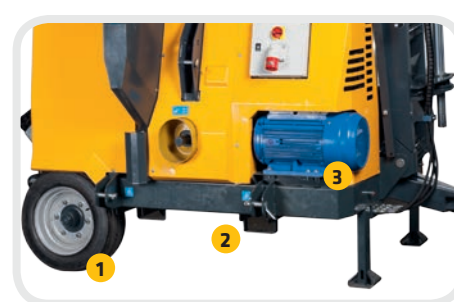
1. Alváz - 200/60 / R14,5. 2. II. vagy III. kategóriás hárompontos csatlakozó. 3. Elektromotoros meghajtás.
