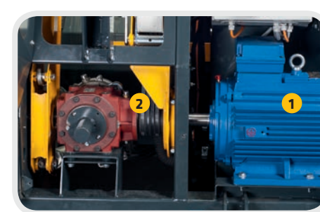
1. 15 kW - os elektromos motor. 2. Kardántengelyes vagy elektromotoros meghajtás.
