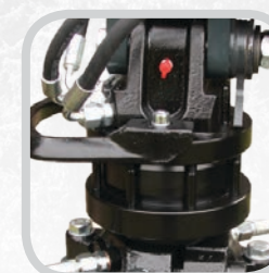
HIDRAULIKUS ROTÁTOR GR 30: Súly: 18,0 kg Teherbírás: 30 kN GR 465: Súly: 28,5 kg Teherbírás: 45 kN
