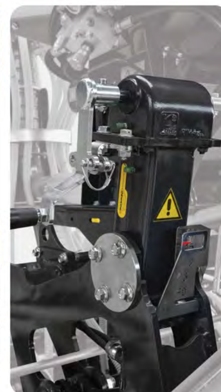
Easy pressure adjustment of seeding elements / Regolazione pressione di semina centralizzata
