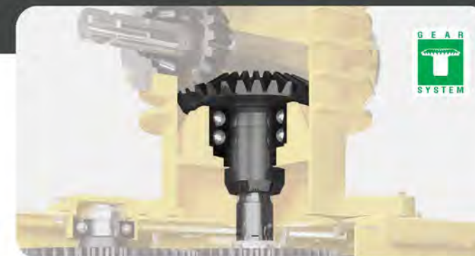
Elongated crown for central rotor protection / Corona allungata per protezione rotore centrale
