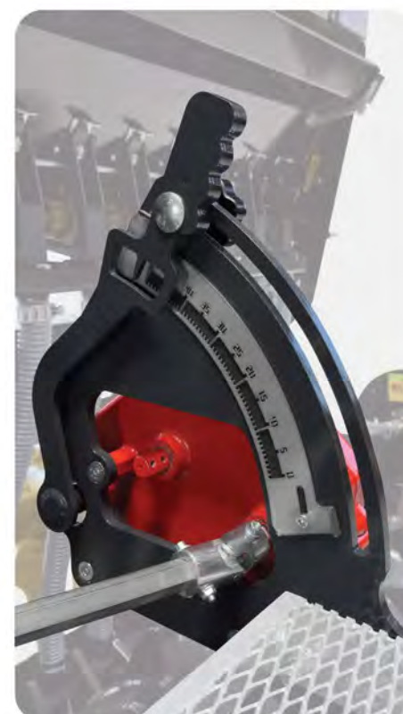
High precision seeding quantity adjustment / Regolazione quantità di semina ad alta precisione
