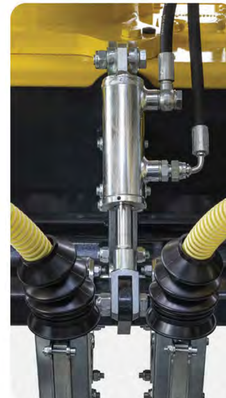
Hydraulic exclusion of seeding elements / Esclusione idraulica degli elementi di semina
