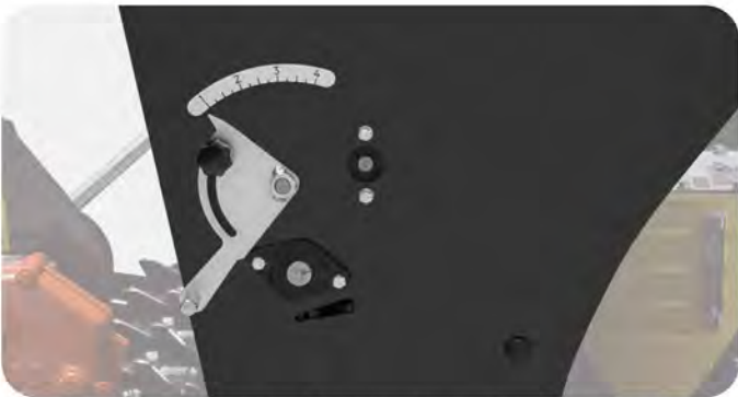
Adjustment of the seeder for different size of seeds / Regolazione della seminatrice per le differenti dimensioni di seme
