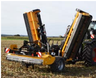
Gyors összecukás és szétnyitás, 3 méternél kisebb szállítási szélességnél.
