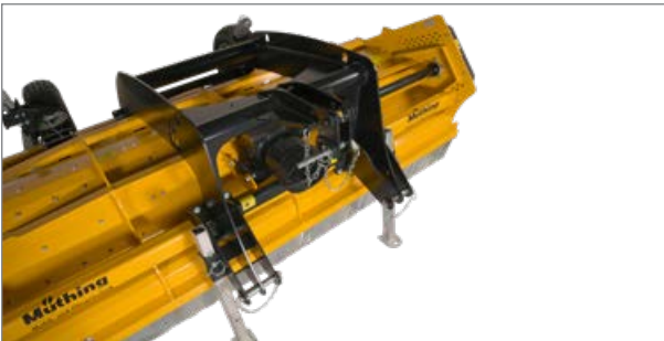
Nagy teljesítményű hajtás max. 250 LE Teljesítményigényig. Csavarokkal szilárdan rögzített, 2+3 kategóriájú hárompontos függesztőkonzol olyan mozgó alkatrészek nélkül, amelyek leállást okozhatnának.
