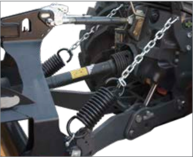
Az első rugós tehermentesítés jó talajkövetést biztosít, és a mellső tengely terhelésével biztosítja a traktor jobb erőátvitelét és kormányozhatóságát (opció).
