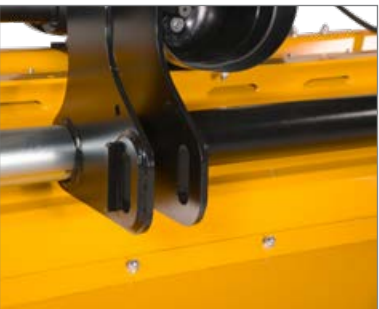
A 2. kategóriánál a hosszlyukak a felső és alsó függesztőkarok csatlakozási pontjainál az elfordítható támasztóhengerrel együtt nagyon jó talajkövetést tesznek lehetővé.
