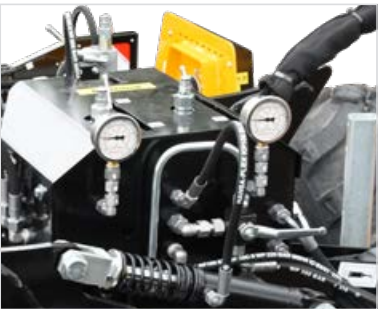
MU-SOFA® hidropneumatikus talajnyomás-tehermentesítő segítségével optimális talajkövetés.
