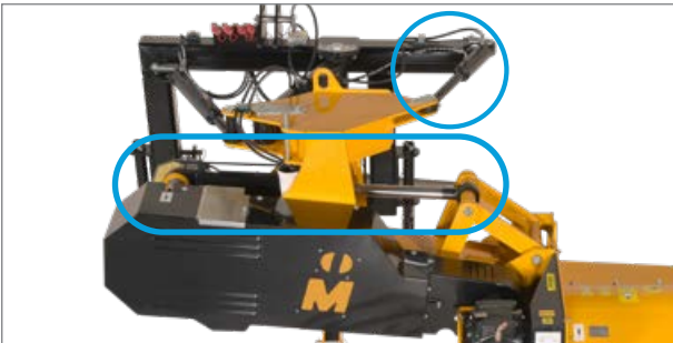
A hidraulikus Non-Stop ütközés elleni biztosítás komoly esetekben hatékonyan kifordítja a mulcsozót az ütközési tartományból.
