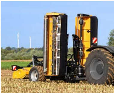
A hidraulikusan beállítható munka- és szállítási helyzet 4 m alatti szállítási magasságot biztosít.
