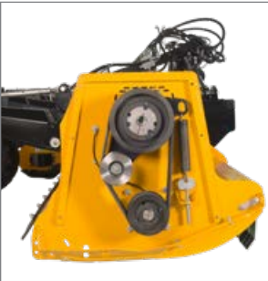
Zavarmentes munka és csekély karbantartási igény a hatékony kivitelű automatikus szíjfértetésnek megfelelően.
