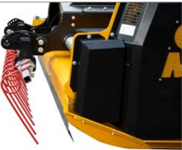
Az integrált Güttler boronák 16 Non-Stop foggal a letaposott tarló felállítására szolgálnak a mulcsozás előtt, valamint finomra törik a talajt.
