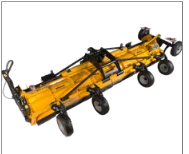
4 talajkímélő támasztókerek a hátra felszerelt MU-Farmer® magasságának beállításához. 180°-ban elfordulhatnak, ez nagyfokú fordulékonyt biztosít a fordulókban.
