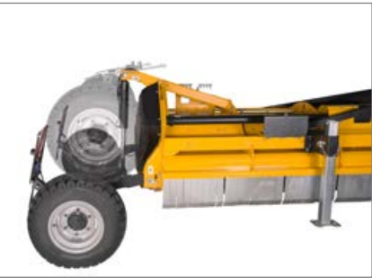
Gyorsan használatra kész: akassza le a gépet és állítsa a közúti futóművet munkahelyzetbe / kapcsolja fel az MU-Farmer® 670-et a gyorskapcsoló rúddal a traktorra és csatlakoztassa a kardántengelyt.
