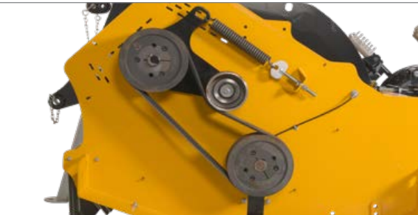
Zavarmentes munka és csekély karbantartási igény a hatékony kivitelű automatikus szíjfeszítésnek megfelelően.
