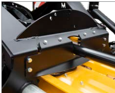
A kiegészítőleg megerősített függesztőbak az erős terheléseknek is ellenáll.
