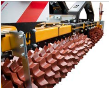
A kombinációban a Güttler követőhenger 38 cm átmérővel és a jól bevált „birkalábnym” tömörítő hatással biztosítja a finom talajt és a tökéletes talajzárást.
