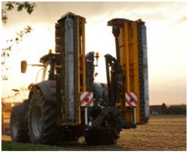
Okos összecsukás és szétnyitás: minimális munkagépmagasság a két mulcsozóház paralelogramma felfüggesztésének köszönhetően.
