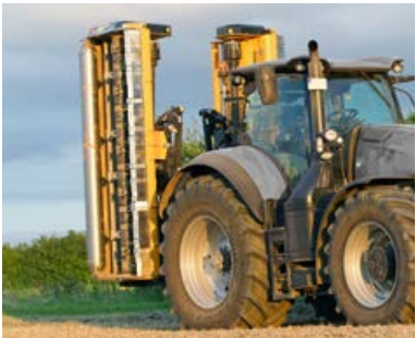
Rövid építési mód, így a súlypont közel van a traktorhoz (Quickhitch-hez használható).
