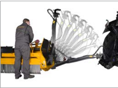
Gyorsan használatra kész: akassza le a gépet és állítsa a közúti futóművet munkahelyzetbe / kapcsolja fel az MU-Farmer® 670-et a gyorskapcsoló rúddal a traktorra és csatlakoztassa a kardántengelyt.
