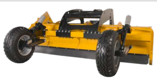
Talajkímélő támasztókerekek a hátra felszerelt MU-Farmer® magasságának beállításához. 180°-ban elfordulhatnak, ez nagyfokú fordulékonyt biztosít a fordulókban. Teljes felületű mélységvezetés a nagy méretű támasztóhengerrel az előre felszerelt MU-Farmer® gépeknél.
