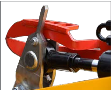
Vario-Shift: a gépkezelő egy jól látható mutató segítségével könnyen tájékozódhat a vágólap aktuálisan beállított aprítási fokáról (opció).
