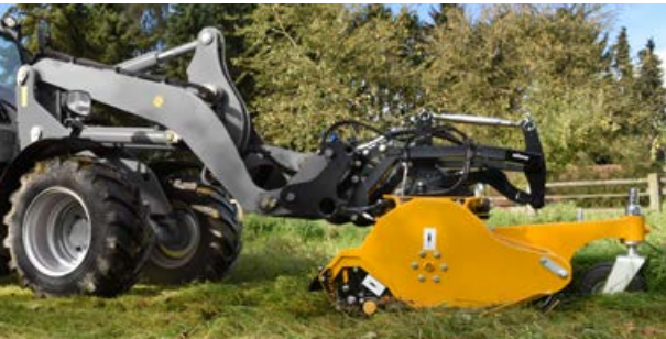
Virtuális vontatáspont, a Műthing egyik szabadalma: a gép kis gördülési ellenállással húzza a mulcsológépet, és nem tolja, így az minden talajkontúr követ.
