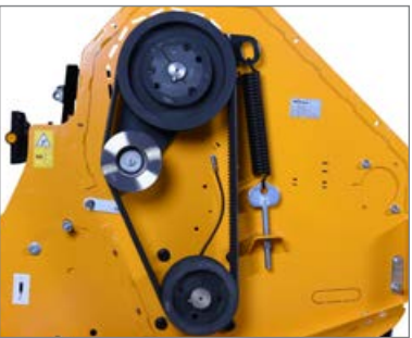
Zavarmentes munka és csekély karbantartási igény a hatékony kivitelű automatikus szíjfeszítésnek megfelelően.
