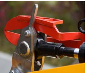
Az új hidraulikusan állítható Vario-Shift vágólap közvetlenül a vezetőfülkéből teszi lehetővé a szársértés és az aprítás mértékének gyors és fokozatmentes beállítását a mindenkori körülményeknek megfelelően (opció).
