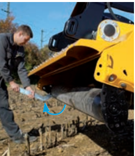
Az elfordítható támasztóhenger egyszerűen, segítő nélkül beállítható.
