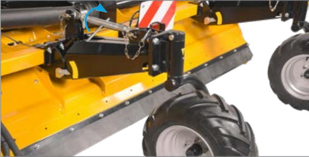
A feszítőzárral gyorsan beállítható a megfelelő vágási magasság.
