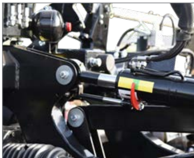
Az optimális munkahelyzet kényelmesen beállítható a jól látható mutató segítségével.
