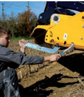
Az elfordítható támasztóhenger egyszerűen, segítő nélkül beállítható.
