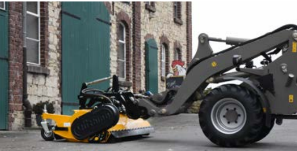
Járműspecifikus csatlakozóelemek: az alacsony csatlakozási pont jó áttekintést biztosít a karok alacsony elhelyezése miatt. A hidraulikus csatlakozók jól hozzáférhetők.
