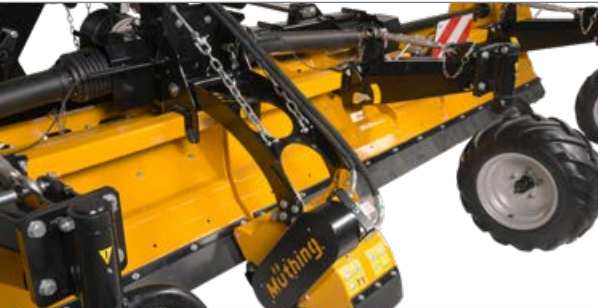
Hidraulikus hajtású sávmulcszó – szükséges hidraulikacsatlakozók: 1 x nyomóvezeték BG 2 csatlakozóval, 1 x nyomásmentes visszatérő vezeték BG 3 csatlakozóval, (opció)
