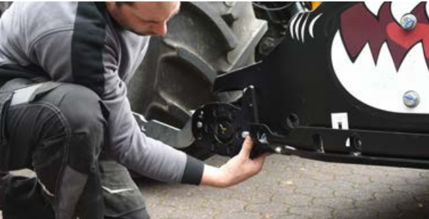
Az elfordítható támasztóhenger egyszerűen, segítő nélkül beállítható.
