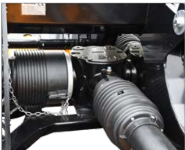
Az átgondolt felépítés lehetővé teszi a nagy teljesítményű dupla hajtómű alkalmazását és az oldalankénti erőbevezetést.
