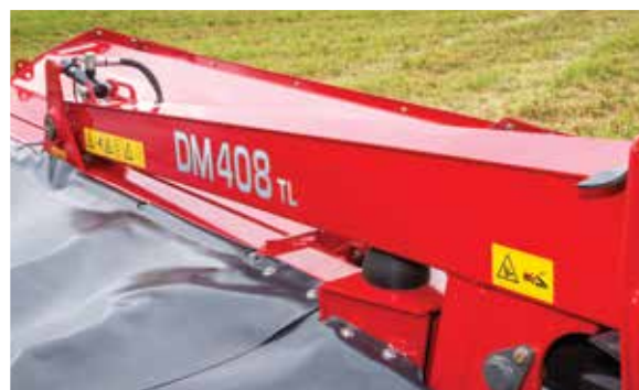
Központi tartó hidraulikus billenéscsillapítással
