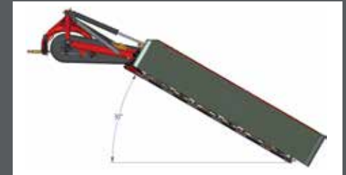
Oldalsó felfogatás: lehetővé teszi a munkavégzést lejtős terepen
