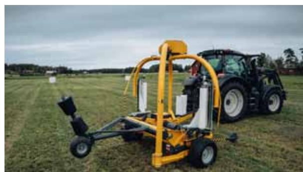
A 1790 Pro közvetlenül bálázóhoz is csatlakoztatható.
