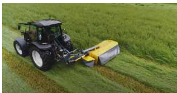
A VC/VCR szériáknál, a vágórész 120 fokban a traktor mögé billenthető, ezzel jelentősen javul a stabilitás szállítás közben.
