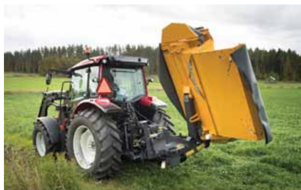
A VC/VCR szériáknál, a vágórész 120 fokban a traktor mögé billenthető, ezzel jelentősen javul a stabilitás szállítás közben.
