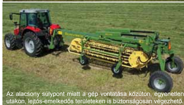
A rotorok központi csapos függesztése a hidro-pneumatikus csillapítással együtt, kiváló talajkövetést eredményeznek.
