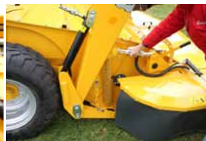
A vágómagasság mechanikusan vagy hidraulikusan állítható.
