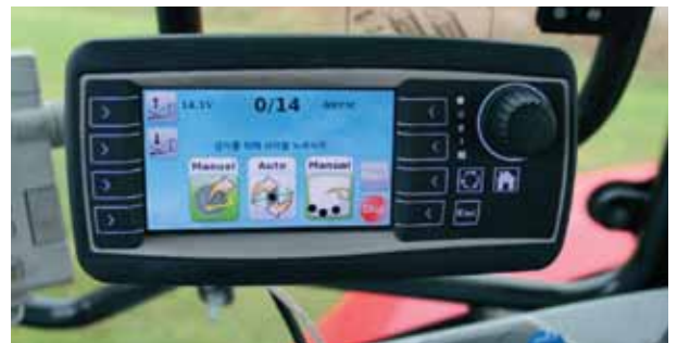
Az ELHO Opus elektronikus vezérléssel, teljesen automata, félautomata vagy manuális módokon vezérelheti a gép működését.
