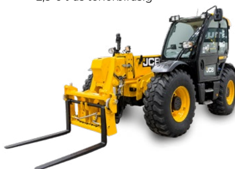
▲ JCB TELESZKÓPOS RAKODÓK 6-20 m-es emelési magasságig, 2,5-6 t-ás teherbírásig
