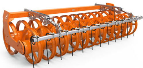
Pálcás boronarendszer a TW és DUW tömörítőhengerhez
