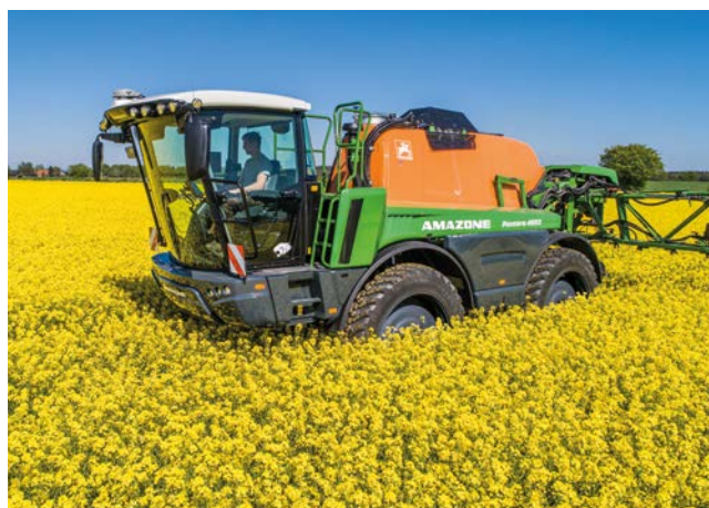
Nagy hasmagasság a növényeket kímélő permetezésért
