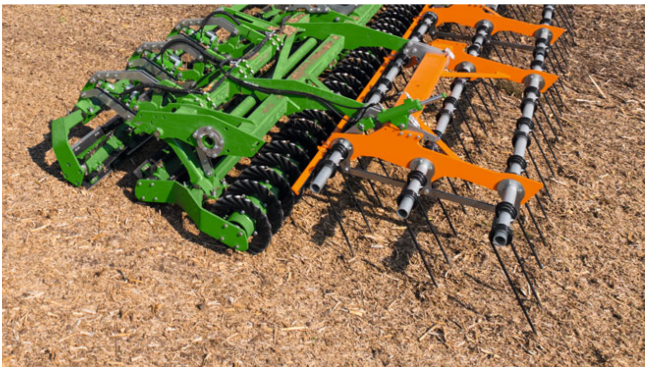
A pálcás borona dőlésszögállítását vontatott gépnél is teljesen hidraulikusan, a traktor fülkéjéből történik.
