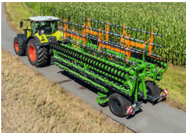
A 12 méter munkaszélességű TopCut 12000-2T közúti szállításhoz 3 méteres szélességre csukható össze.
