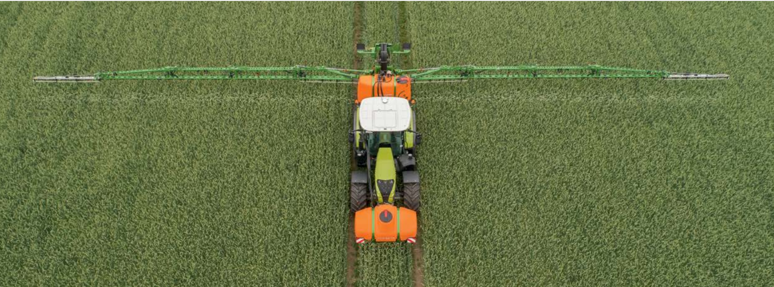
UF 2002 gép Super-S2 szórókerettel, 30 m munkaszélességgel és FT 1502 fronttartállyal
