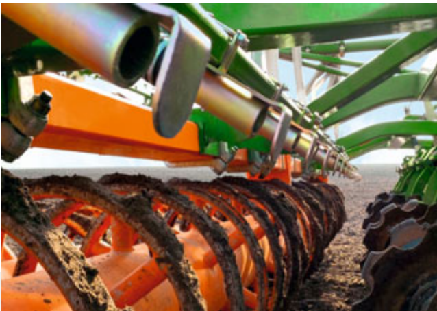
Vetőmag-ütközőtányér a henger előtti felszíni kijuttatáshoz
