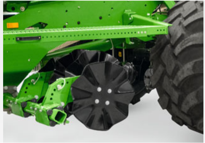
A hullámtárcsa-kerekes nyomvonal-eltávolító mechanikus magasságállítása
