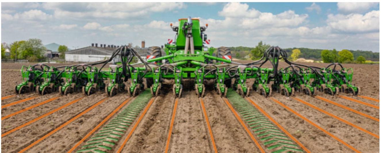
A Precea tengely menetnyomai a vetőmagsorok között kerülnek elvezetésre – duplikáció nélkül, a talaj védelme érdekében
