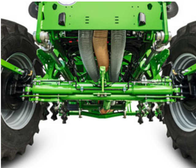
A teleszkópos tengely hidraulikus munkahengerei
