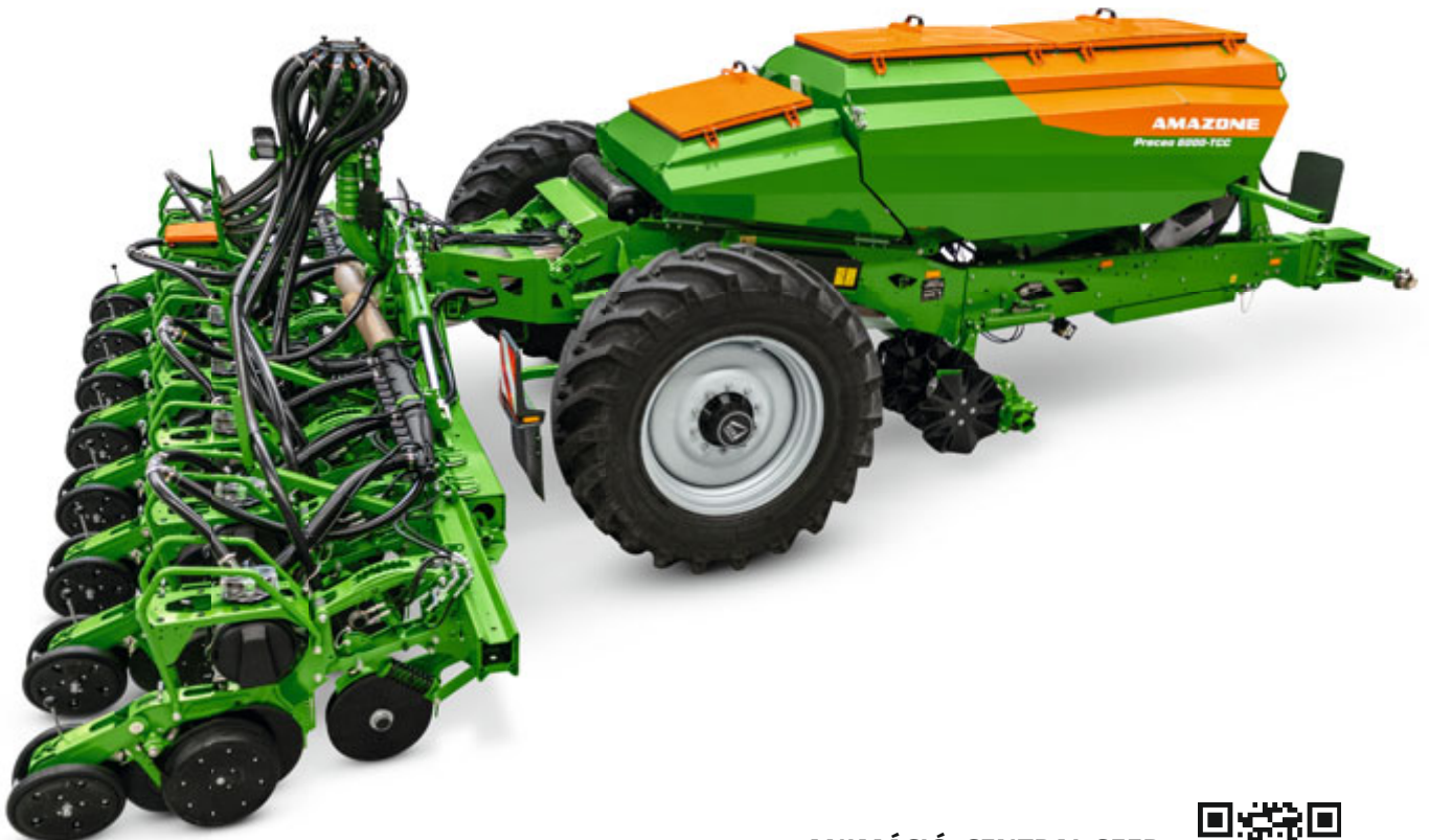
Precea 6000-TCC központi vetőmagtartállyal és központi műtrágyatartállyal
