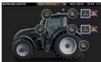
A munkalámpák beállítását is a 9"-os kijelzőn tehetjük meg. A munkalámpák ki/ bekapcsolását és figyelmeztető lámpa bekapcsolását a kartámaszon található nyomógombbal végezzük.
