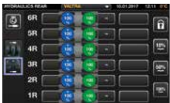
Bármelyik vezérlőhöz hozzárendelhetjük a vezérelt funkciót. Első vagy hátsó kihelyezett szelepek vezérlését, homlokrakodót vagy front hidraulikát vezéreljük onnan ahonnan szeretnénk.
